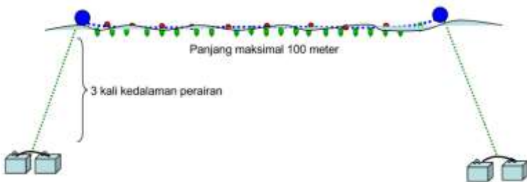
Gambar 5.6 Konstruksi long line lajur
